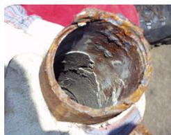
**Bild 8:** TENORM Ablagerungen in Wasserrohren
