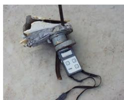
**Bild 4:** Cs-137 Strahler in Dichtesonde 65 MBq
