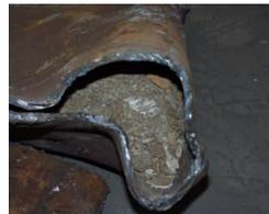
**Bild 9:** NORM Ablagerungen in Bergbauleitungen
