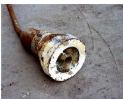
**Bild 3:** Cs-137 Strahler in Tiefensonde 165 MBq
